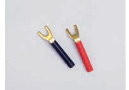
叉形端子转换器 【TL45】 红/黑 各1个 1000V/ CAT II max 20A
