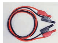
测量引线 【TL40】 红/黑 各 1 根 1000V/ CAT II max 32A 长度: 1m
